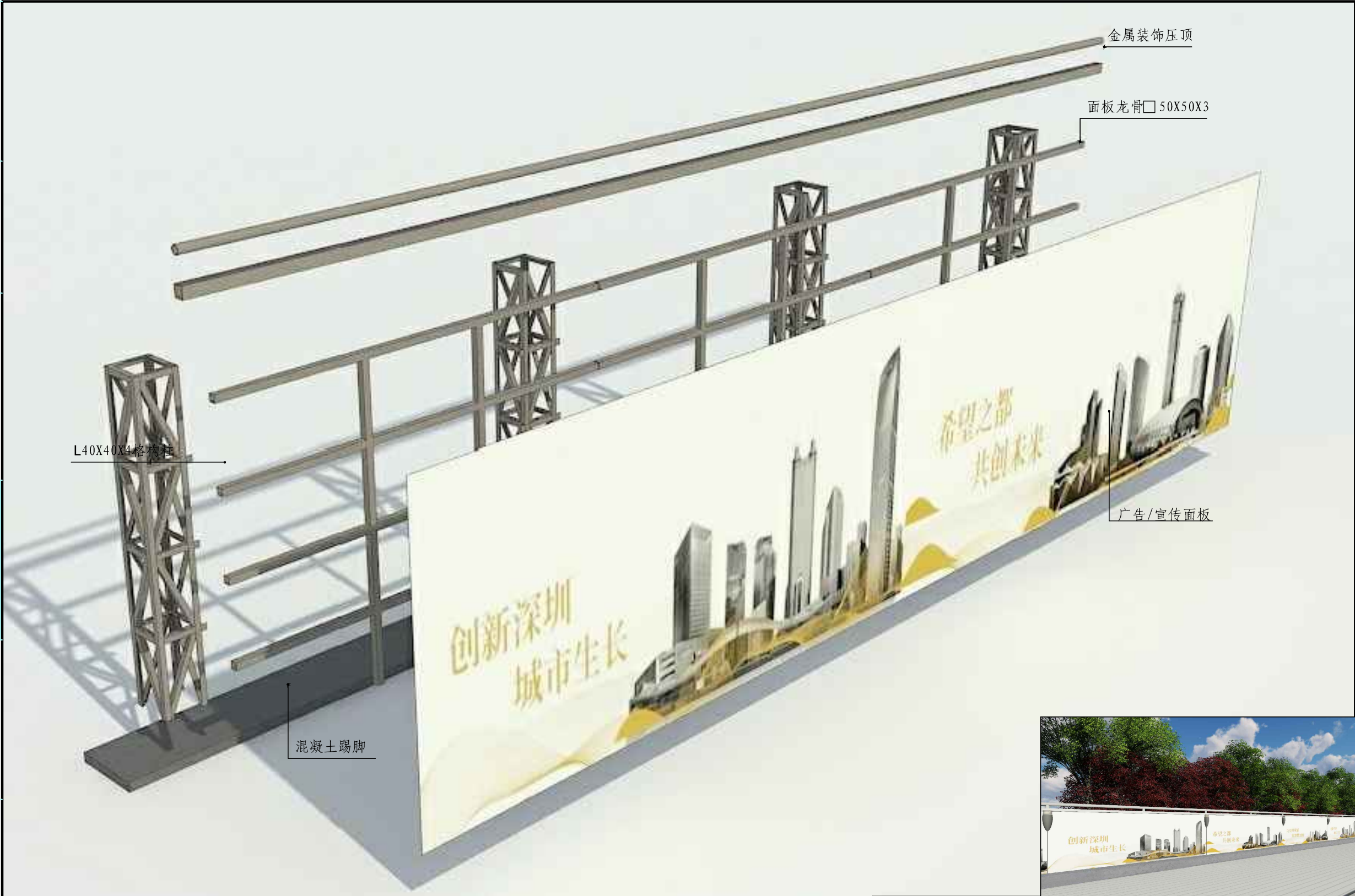
桁架钢结构围挡类型C拆分图
