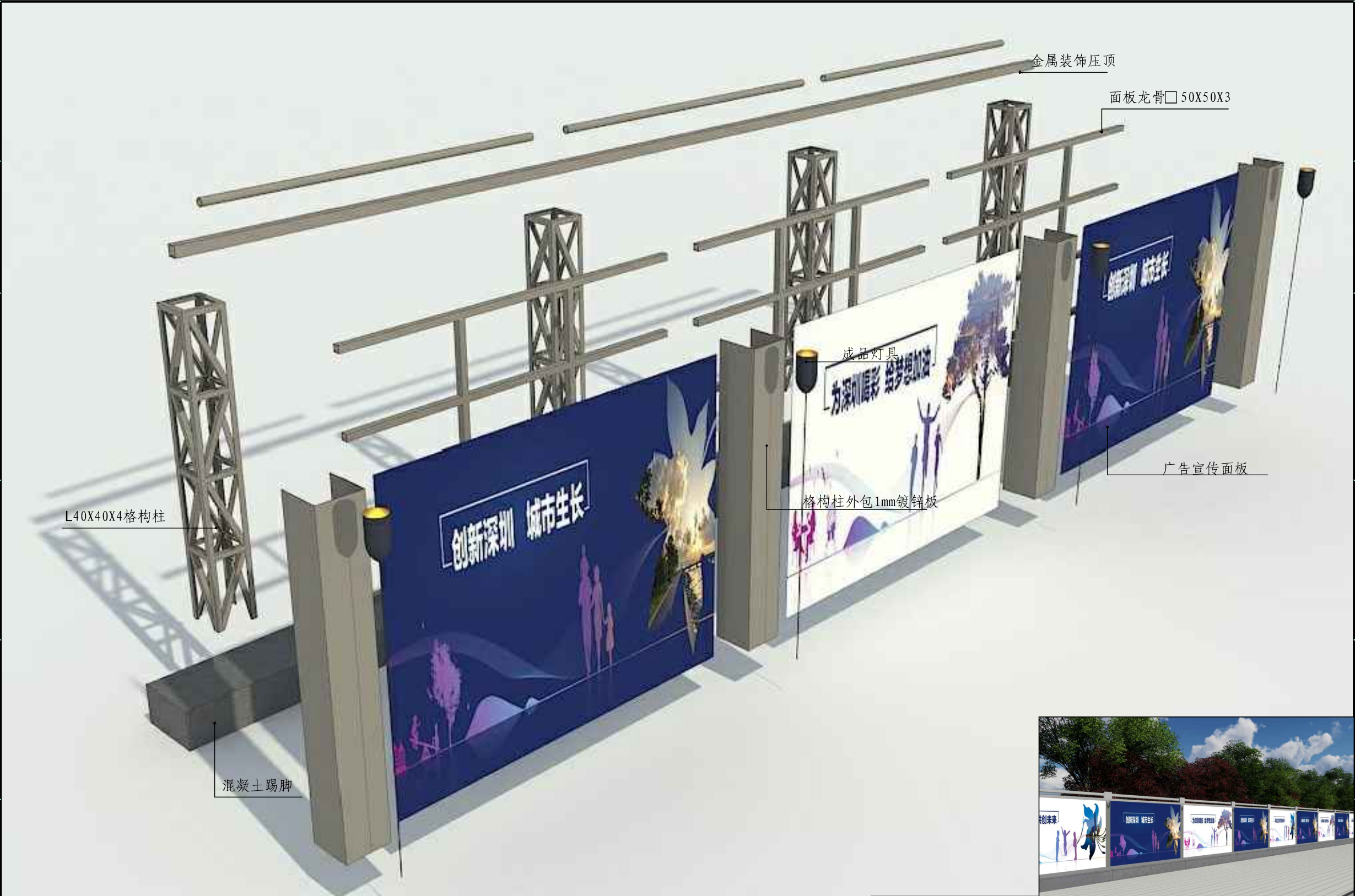
桁架钢结构围挡类型D拆分图
