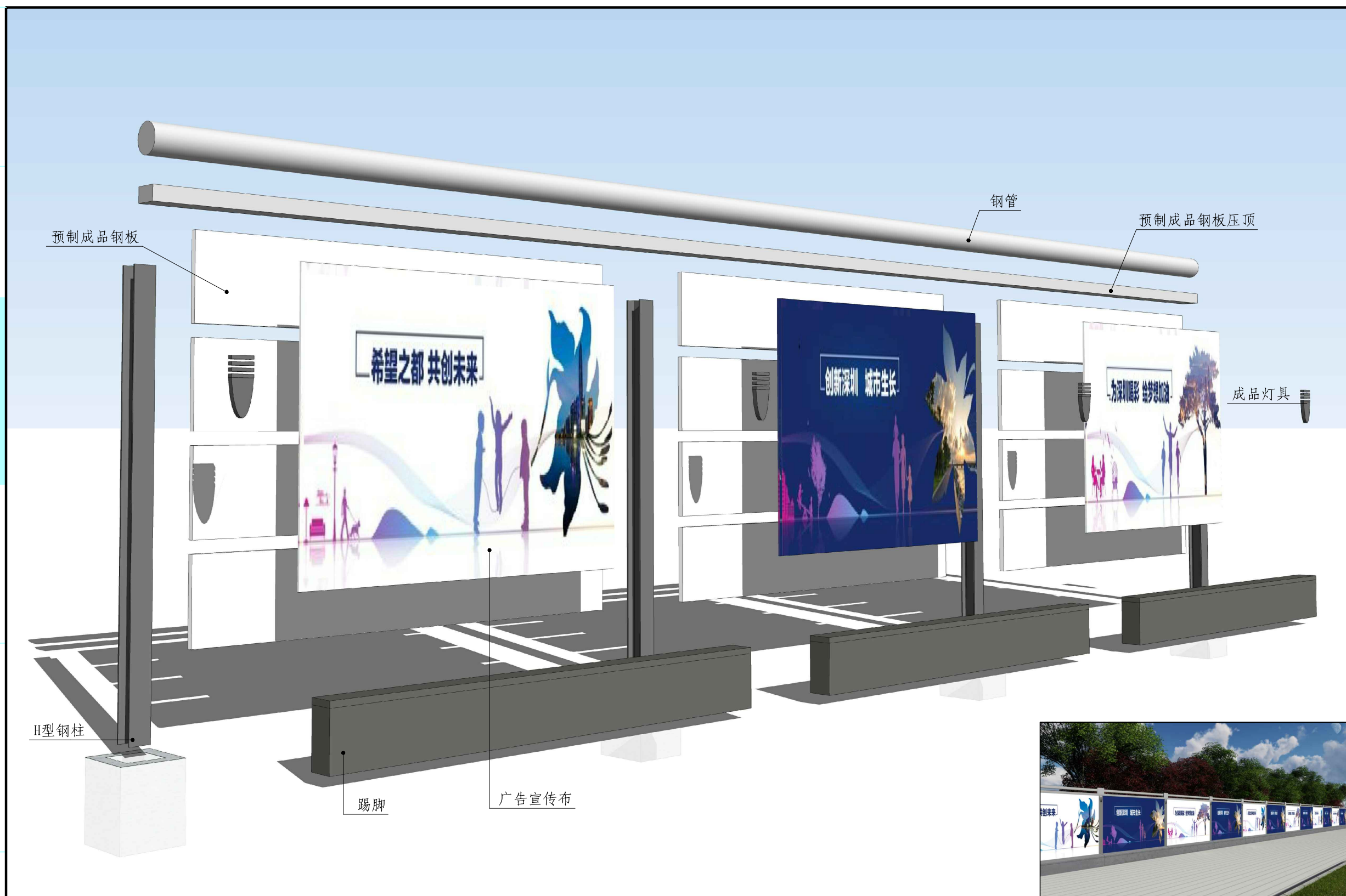
装配式钢结构围挡类型C拆分图
